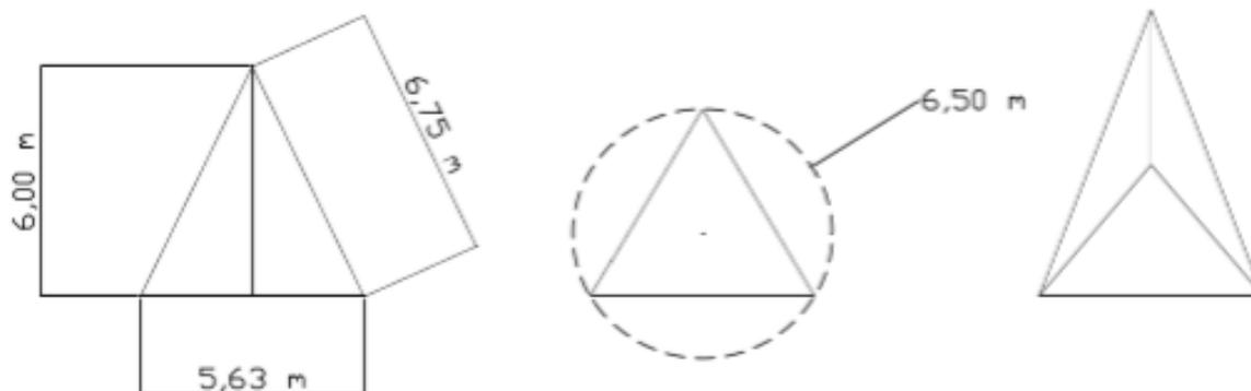
**Pour une hauteur de 4m :** 3 mâts de 4,5m reliés entre eux au sol par des câbles de 5,63m pour un empâtement au sol total de 4,33m de diamètre.
