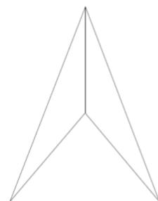
**Pour une hauteur de 6m :** 3 mâts de 6,75m reliés entre eux au sol par des câbles de 5,63m pour un empâtement au sol total de 6,5m de diamètre.
